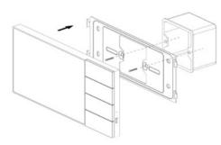
① 在墙上装好86型暗盒(自备)或预留相应尺寸的安装位,在其中预埋DC12V供电线或安置好强 电转DC12V电源模块(另行购买),确保能稳定提供DC12V 1A供电。安装时请关闭电闸。
